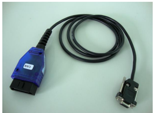
Cabo CAN. Realiza programação de chaves via diagnóstico.
